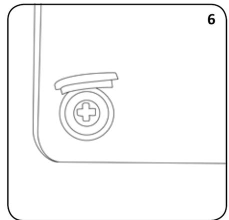
Legen Sie das A4-Schild auf die 4 Befestigungslöcher und schrauben Sie eine der Schrauben in den Dübel. Anschließend befestigen Sie alle 4 Schrauben mit dem Schraubenzieher.
