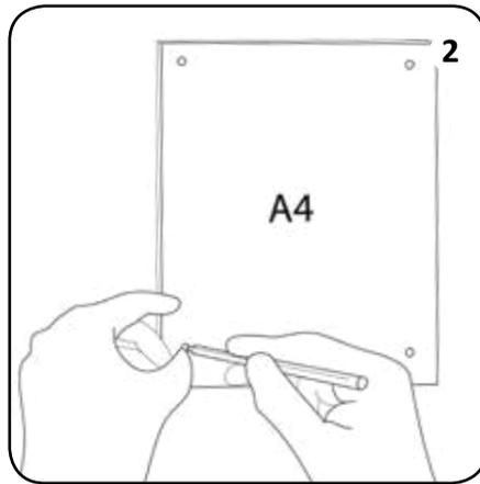
Platzieren Sie Teil 1 an der Wand 60mm über der Oberkante von Teil 5. Übertragen Sie die 4 Befestigungspunkte auf die Wand durch die 4 Löcher im A4-Schild. Stellen Sie sicher, dass das Schild horizontal und mittig gerade ist.
