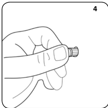
Schieben Sie je einen Dübel (Teil 2) in die 4 Bohrlöcher. Bringen Sie die Dübel, unter Zuhilfenahme des Hammers, zum bündigen Abschluss mit der Wand.
